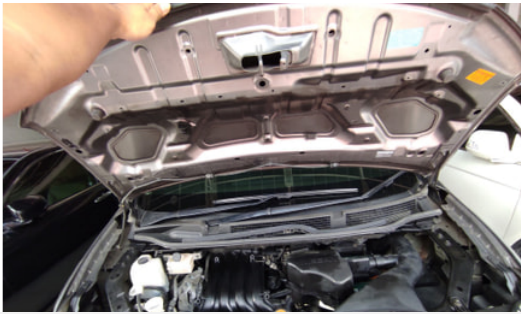
Tiang Kap Mesin Tidak Ada
