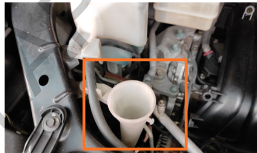
Tutup Air Wiper Tidak Ada
